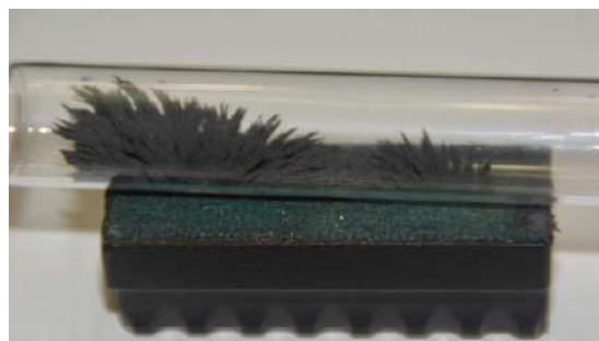
Obtención de limaduras de hierro por imantación
